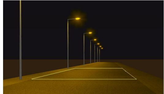
Figuur 3.1 rekenvlak voor verkeerswegen
